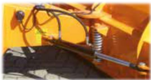
Hydraulisk sving med 2 cylindre, 1 dobbeltvirkende olieudtag (ekstraudstyr)
