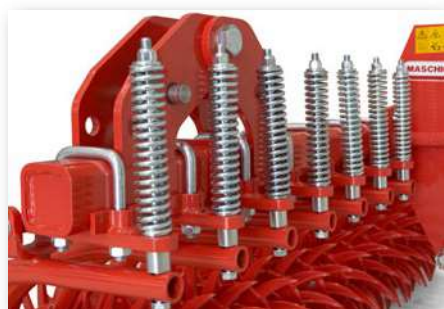
Pressione al suolo regolabile meccanicamente tramite molle
